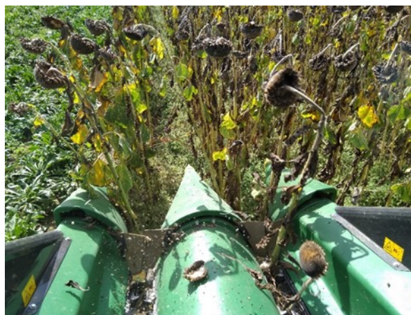
Figuur 7 Dorsen van de zonnebloemen met de Haldrup C65 proefveldmaaidorser van PIBO-Campus vzw, uitgerust met Geringhoff Maïs Star* 2-rijige maïsbeek.
