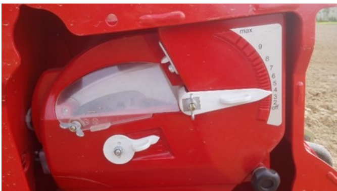
Figuur 1: Zonnebloemzaden in de zaadhouders van de maïszaaimachine. De afstrijkers werden zodanig ingesteld dat in de gaten van de zaaischijf slechts 1 zonnebloemzaadje zat.
