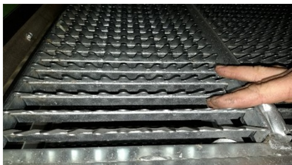
Figuur 8 Opening van de zeven. De zeef werd zodanig gekanteld dat vingers er net tussen pasten.
