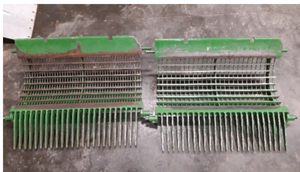
Figuur 9 Links: tegendorser voor granen. Rechts: tegendorser voor maïs en zonnebloemen. De holtes in de tegendorser zijn groter waardoor de zonnebloemzaden er makkelijk door vielen. De holtes kunnen worden afgesloten met staven, maar dit wordt niet aangeraden bij het oogsten van zonnebloemen.
