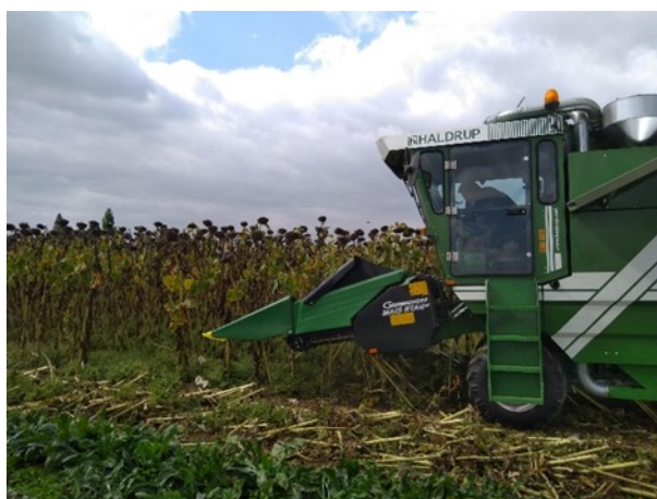
Figuur 6 Oogst van de biologische zonnebloemen op 12 september 2018. De oogst gebeurde met een Geringhoff Maïs Star* bek voor maïs. Na de oogst werden de stoppels geklepeld.
