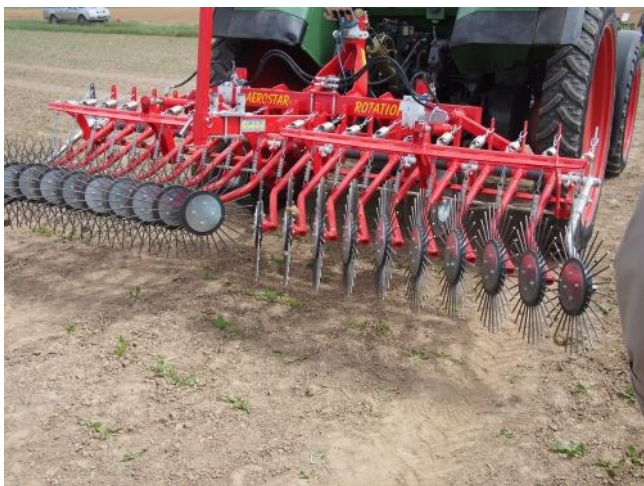
Foto 3: De roterende wiedege of "roto-étrilleuse" 'Aerostar Rotation' van Einböck in versie van 3 meter.
