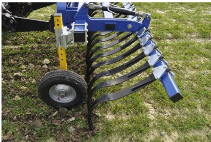
Foto 8: Voor een goede werking van de graanschoffel 'TH' van Treffler zijn een precieze zaai en een rijafstand van 15-20 cm ideaal.
