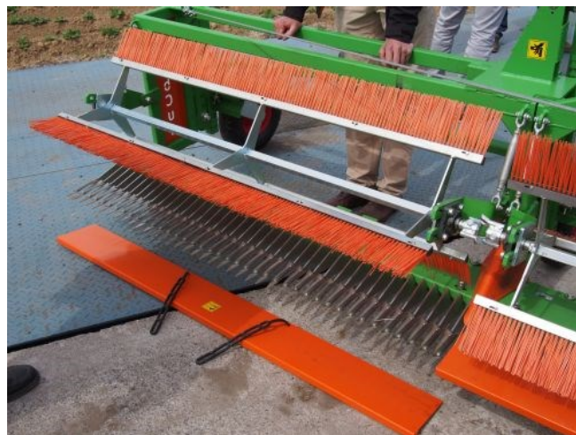
Foto 9: De mechanische onkruidmaaier 'CombCut' wordt in de fronthef gebruikt om ontwikkelde onkruiden in granen, gras of andere teelten af te snijden en uit te putten.
