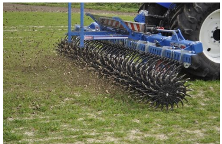
Foto 2: Vanometaal demonstreerde de lepelwieder of hoe rotative 'Rotanet' van Carré in versie van 6 meter.
