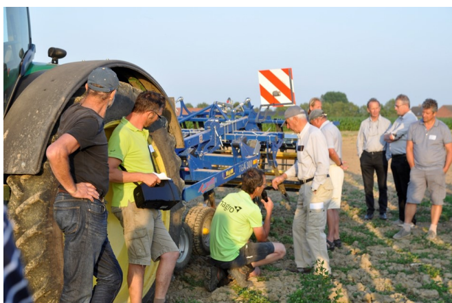
Foto: De TGA cultivator van Treffler bleek dit voorjaar erg effectief voor de vernietiging van groenbemers
