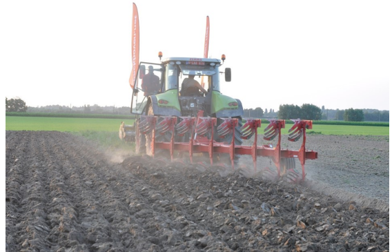
Foto: Ondiep ploegen met de Ovlac ekoploeg
