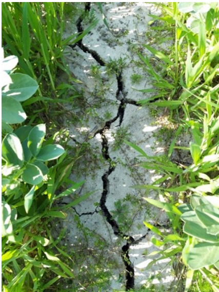
Figuur 2: Krimpscheur door de droogte, genomen op 17 april
