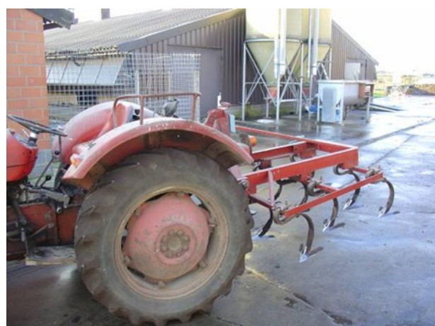
Figuur 2. Links: apparatuur om het stalklimaat in kaart te brengen. Rechts: de cultivator waarmee het compostsubstraat opengetrokken werd, met op de achtergrond de toegangspoort tot de stal.
