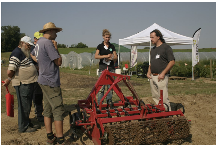
Foto: De Vibroplanche, een ontwerp van Atelier Paysan, voor het bewerken van vaste bedden.
