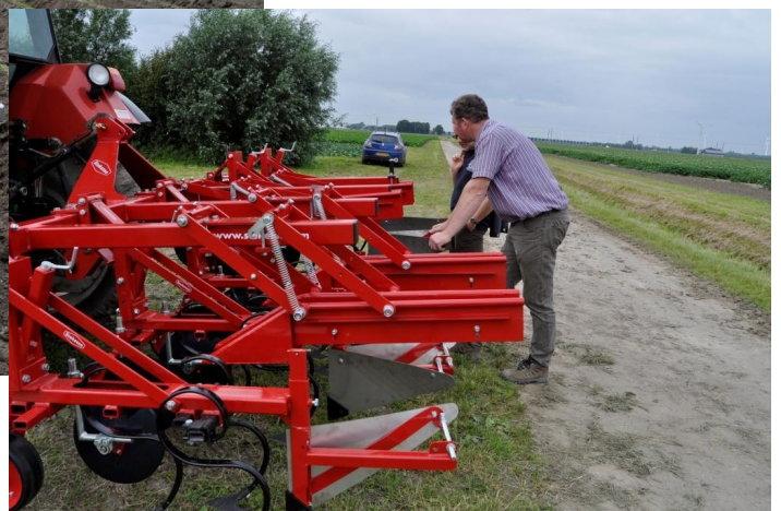
Foto's: De combinatie van Steketee bestaat uit een schoffeleenheid voorop de tractor en een aanaardeenheid achterop de tractor. Beide kunnen ook afzonderlijk gebruikt worden.
