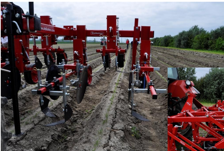
Foto's: De combinatie van Steketee bestaat uit een schoffeleenheid voorop de tractor en een aanaardeenheid achterop de tractor. Beide kunnen ook afzonderlijk gebruikt worden.
