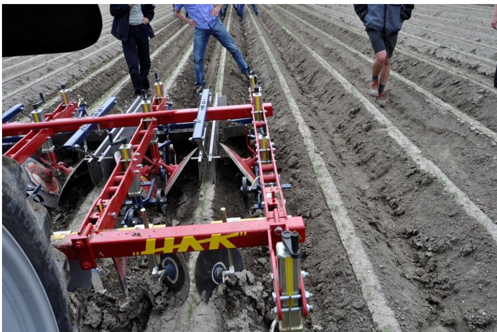
Foto: De schoffelmachine voor ruggenteelt van HAK combineert vijf bewerkingen.
