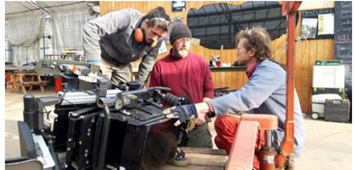
Figuur 1: tijdens de "bricoleursweek" in 2020 werden verschillende elektrische rolstoelen omgebouwd tot wiedbedden.
