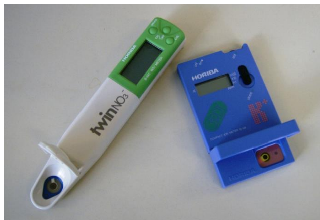
Figuur: Toestellen voor sneltest: stikstof (links), kalium (rechts)
