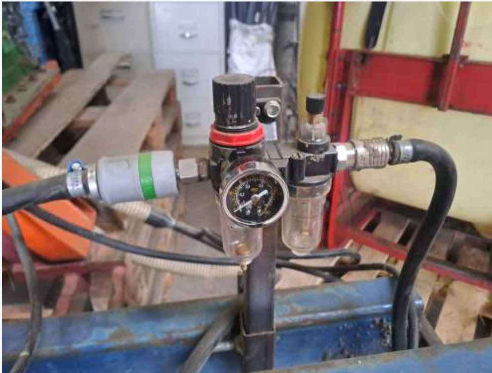
Vochtafscheiding dichtbij de pistolen
