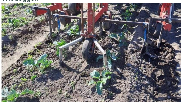
Schoffelen in de rij o.b.v. RTK-GPS
