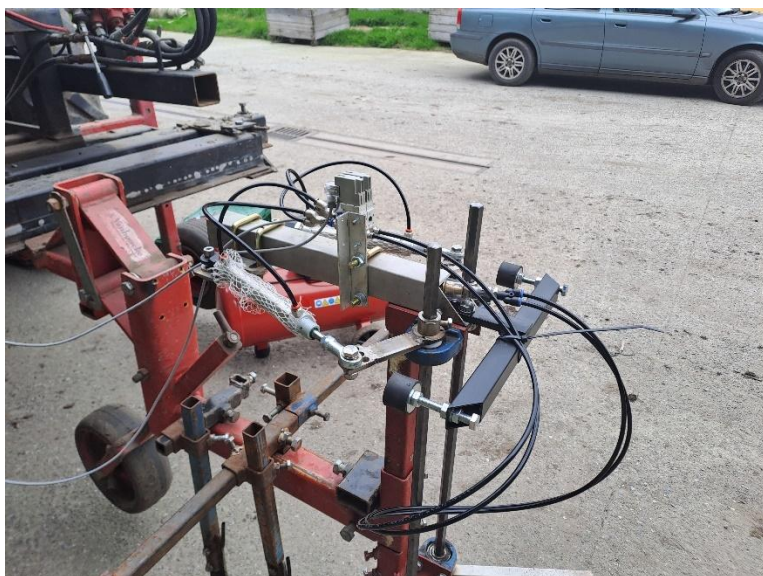
Figuur 1: De schoffelmessen voor in de rij worden in en uit de rij gebracht door middel van twee pneumatische cilinders.
