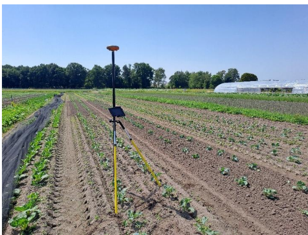
Figuur 1: Manuele RTK-GPS-stok. Door de stok waterpas te houden kan de positie van de punt van de stok op de bodem correct ingemeten worden.
