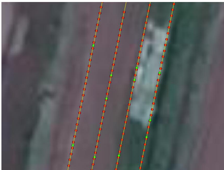
Figuur 2: Voorbeeld van het raster waarop geplant werd (rode bollen) en de werkelijk ingemeten plantposities (groene bollen) geprojecteerd op de AB-lijn (gele lijn).
