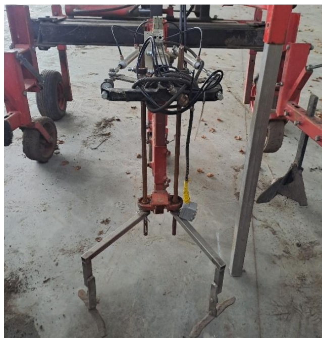
Foto 1: Opstelling met schoffelmessen om in de rij te schoffelen op basis van de rtk-gps locatie van de planten, opgebouwd op een bestaande schoffelbalk.
