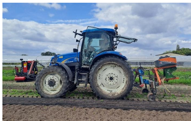
Foto 2: Opstelling voor het wieden met een compressor in de frontheef en zandstraalpistolen en reservoir voor de partikels achteraan.
