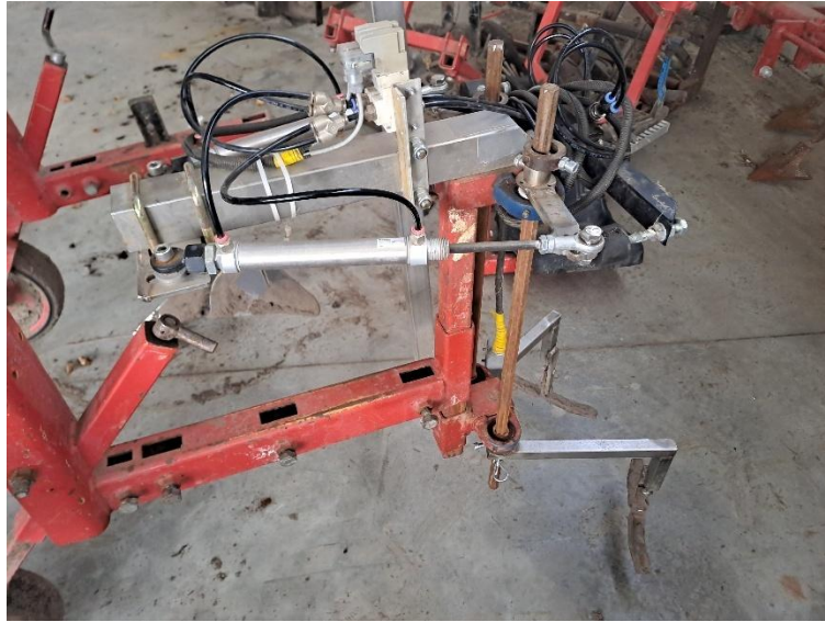
Figuur 3: De messen draaien om een as en kunnen zo in en uit de rij gebracht worden.
