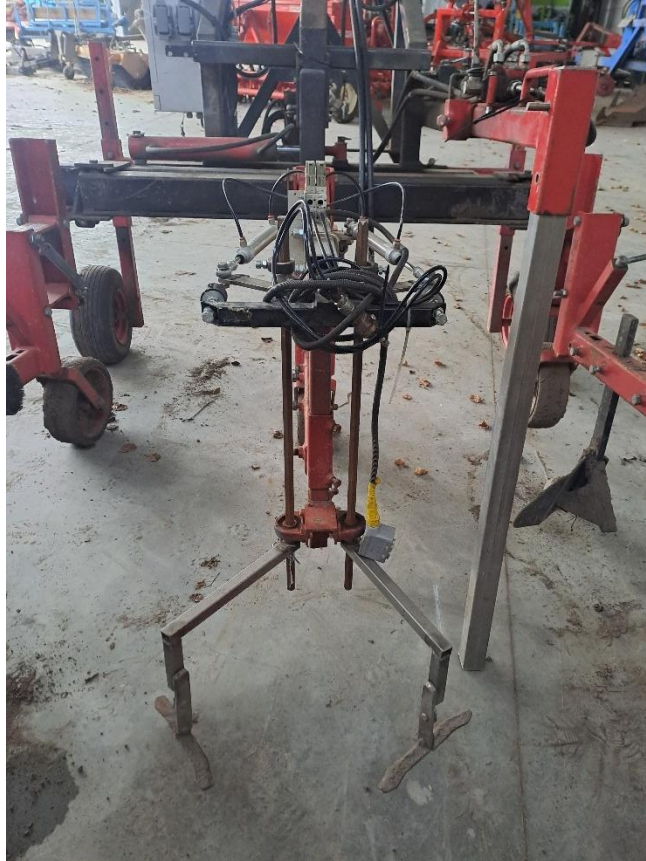
Figuur 2: Deze module voor het schoffelen in de rij kan op een bestaande schoffel opgebouwd worden.
