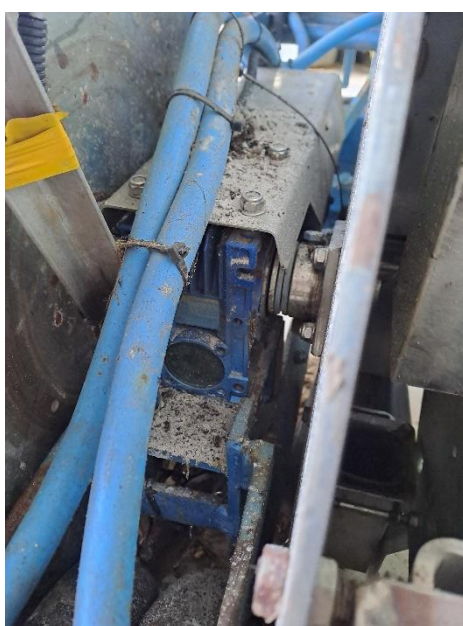
Figuur 1: D.m.v. een elektromotor op de plantmachines kunnen planten precies afgezet worden op basis van een signaal afkomstig van het gps-systeem.
