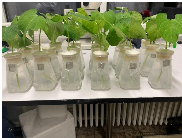
Figuur 13: De voorbereide bonenplantjes in een PET-fles. De fles is afgesloten met een mousse en een laag gips, en is voorzien van een opening afgedekt met fijnmazig insectengaas. Bron: auteur.
