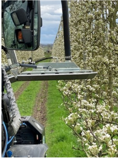
Foto 3: Horizontale stand van de machine voor dunning van het gestel bij Celina/QTee®
