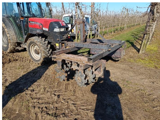
Foto 2: Balk met hak-schijven voor 1 ste grond-bewerking
