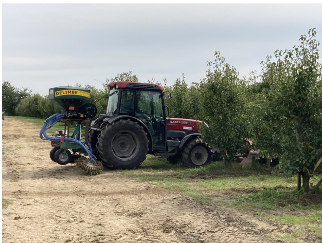
Foto 2: Het zaad valt net voor de vingerwieder zodat het oppervlakkig wordt ingewerkt.
