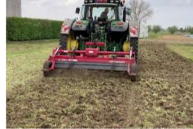
Figuur 8: grasklaver vernietigen met de Geohobel grondbraaier
