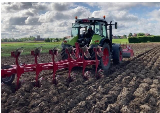
Figuur 9: ondiep en bovenover ploegen met de ecoploeg
