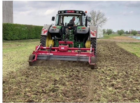
Figuur 8: grasklaver vernietigen met de Geohobel grondbewerking
