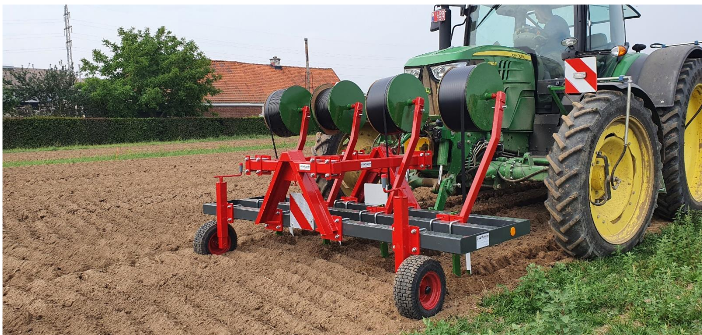
Figuur 3: met een vrij eenvoudig werktuig worden druppelsslangen ondergronds aangebracht
