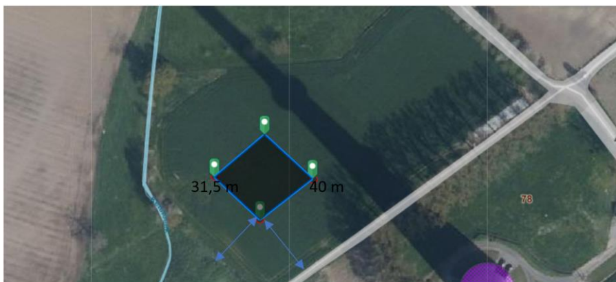
Figuur 5.2: Inplanting proefveld op 40 en 31,5 m van de perceelsgrenzen om randeffecten te vermijden
