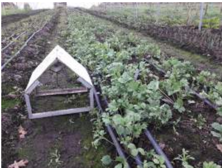
Foto 2: Plaatsing temperatuursensor (Testo175H2) met bodemsonde op praktijkbedrijf A (28/01/20)
