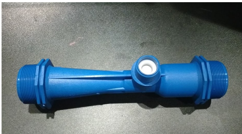
Foto: Venturi-systeem: Doordat het water in de versmalling een snelheidsverhoging ondergaat, ontstaat op die plek een drukverlaging; het venturi-effect. Op deze manier kan een vloeistof met opgeloste meststoffen worden aangezogen.
