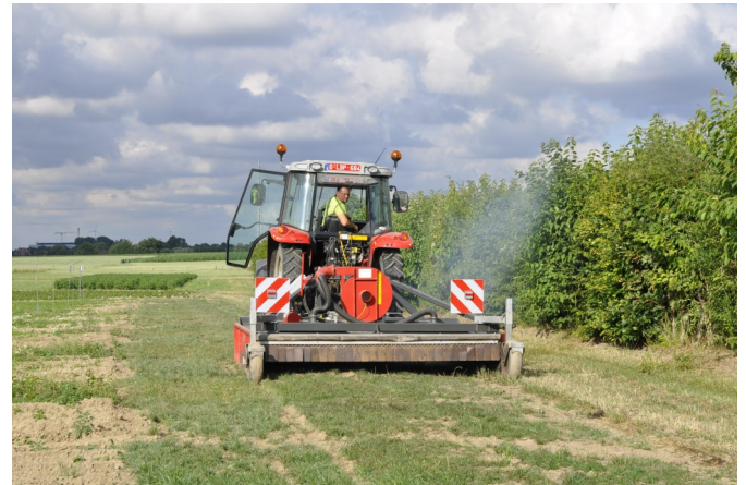
Foto: Onkruidbrander van Vanhoucke (Moorslede) : een geoptimaliseerde luchtondersteuning zorgt voor een optimale verbranding en bijgevolg voor een zuinig gasverbruik.
