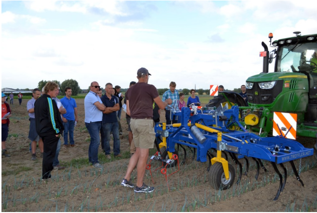
Foto: De Treffler schoffelmachine (TH series) heeft een rij gidstanden die een spoor volgen met daarachter geveerde schoffelmessen. De machines steunen voor- en achteraan op wielen. Man@Machine (Nederland)
