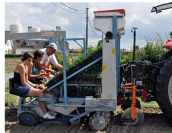
De tussenbok met schijfbesturing wordt tussen de plantmachine en de tractor gekoppeld.
