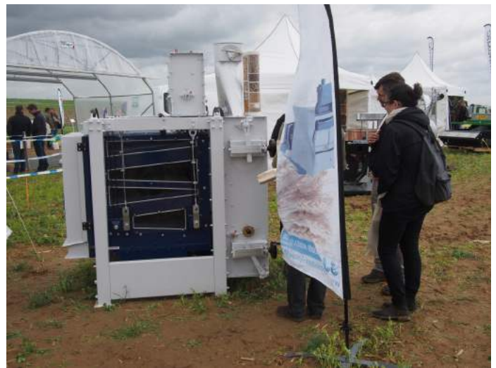
Trieer- en schoonmachine voor diverse producten, 2 afvoer- (links) en 1 geschoonde restfractie (rechts) (Schneider Jaquet & Cie)
