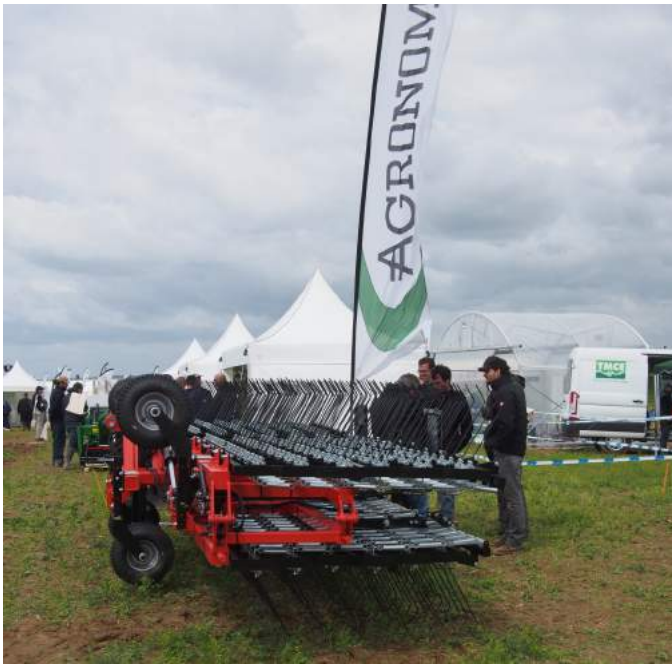
Wiedeg met veren die naar achter opspannen (Agronomic). Een zware constructie en de druk van de tanden is niet gelijk op verschillende posities.
