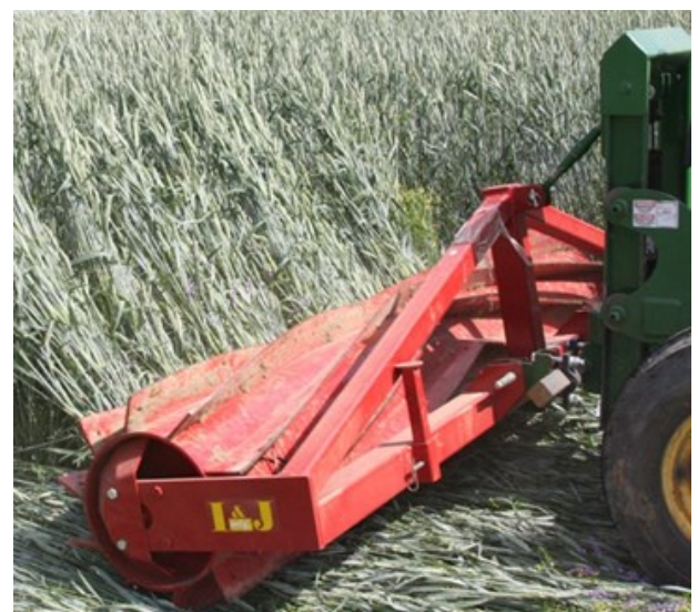
Figuur 1: De roller-crimper walst tegelijkertijd het gewas plat en knakt de stengels
