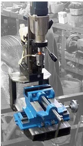
Magnetische boormachine op zelfgebouwd voetstuk en bankschroef
