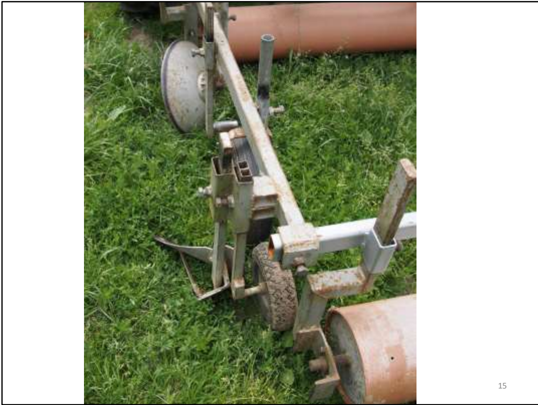
Volleveldse folielegger Peter Frischkorn, vanaf boven: walsrol, schijf die een voor maakt, wiel die folie strekt, ploegelement dat de voor sluit, aandrukwiël, rol met merkers
